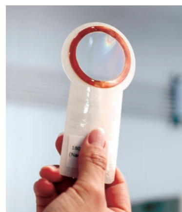
分離ナノ膜。膜の厚さわずか34nm
